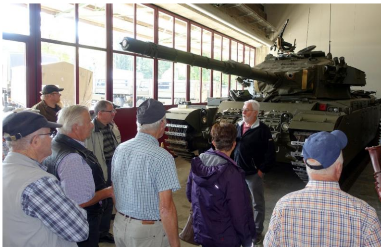
Pz 55/57 Centurion – 1956-92, 51 to (leer); 4-Zylinder/4-Takt Benzinmotor 650 PS; 10.5 cm Pz Kan; 2 Mg 7.5 mm; 4 Mann – damaliger Bestand: 312 Stk.
