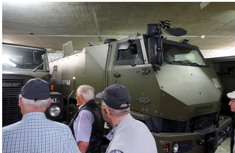
Duro III P 6x6 «Mowag» - leicht gepanzerter Mannschaftswagen; 12 to (leer); 6 Zylinder Diesel-Motor; 250 PS; 1 12.7 mm Mg; 11 Mann.
