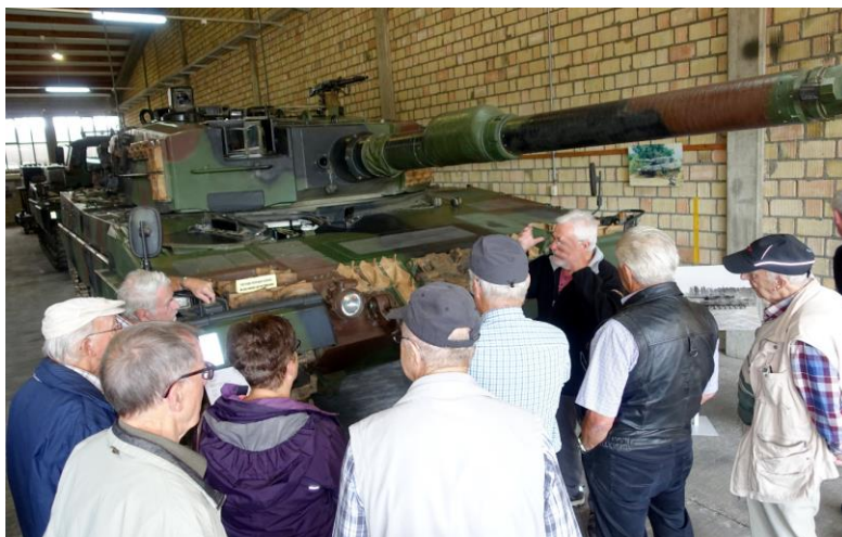
Pz 87 WE2006 Leopard – 1987/2006-heute; 56.6 to (leer); 12 Zyl. V90° 4-Takt Dieselmotor mit Turbolader, 1500 PS; 12 cm Glattrohr Pz-Kanone; 7,5 mm Pz Mg (Rohrparallel); 7,5 mm Mg; 4 Mann – Bestand: 264 Stk.
